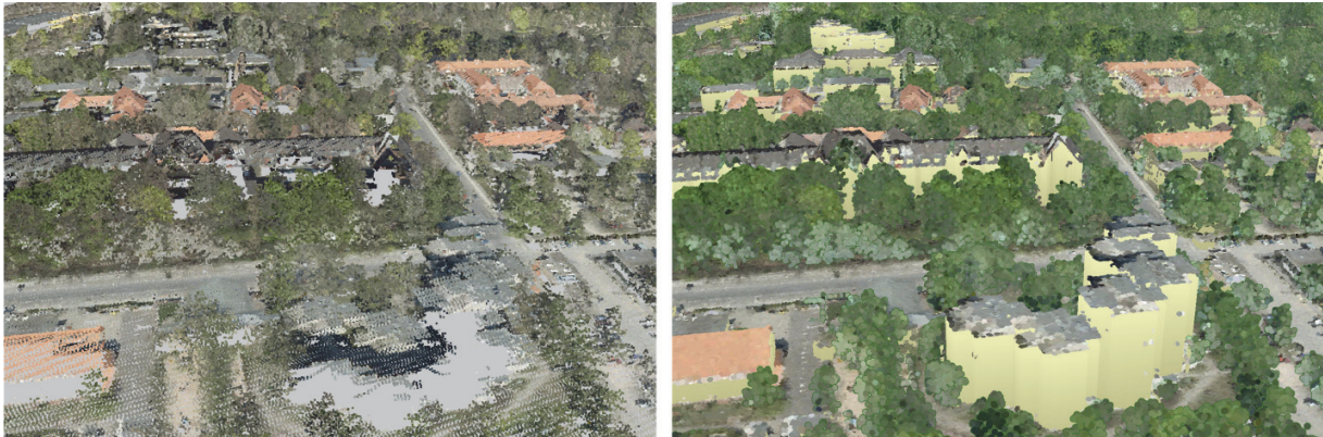
Abb. 1: (links) - 3D-Punktwolke einer Befliegung dargestellt mit Luftbildfarben und einem einheitlichen Darstellungsstil. (rechts) - Darstellung derselben 3D-Punktwolke unter Berücksichtigung semantischer Attribute: Gebäudefassaden erscheinen als geschlossene Oberflächen, Tiefenunterschiede zwischen benachbarten Punkten können besser abgeschätzt und einzelne Strukturen leichter identifiziert werden. (Vgl. RICHTER ET AL. 2015)
