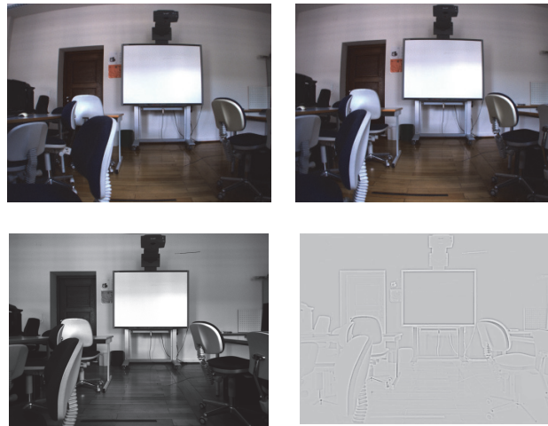
Abb. 16: Bumblebee Auswertungen. Oben: li und re RGB Aufnahmen, unten: korrigiertes Graubild und extrahierte Kanten (Quelle: CHENG 2014)
