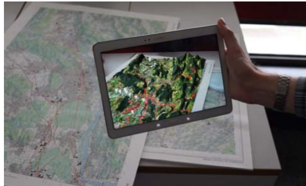
Abb. 7: Augmented Maps auf einem Samsung Galaxy Tab. Überlagerung eines 3D-Landschaftsmodells mit den Routen des öffentlichen Verkehrs und einem Live-Zugriff auf die entsprechenden Fahrplandaten
