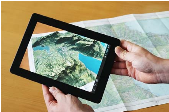
Abb. 6: Augmented Maps mit der Überlagerung eines 3D-Landschaftsmodells über einer Schweizer Landeskarte 1:25'000 auf einem ASUS Transformer Pad
