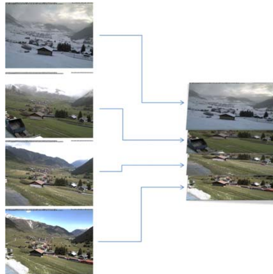
Abb. 3: Multimarker aus mehreren Einzelbildern mit gleicher Lage und Orientierung, jedoch bei unterschiedlichen äußeren Bedingungen aufgenommen
