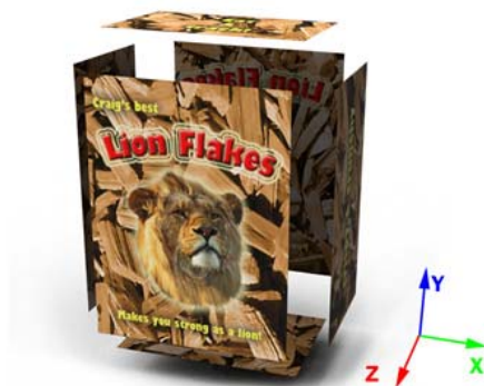
Abb. 1: Multimarker aus 6 Einzelbildern deren relative Position und Orientierung bekannt ist. Gemeinsam definieren alle Einzelbilder ein Objektkoordinatensystem (Vuforia, 2015)
