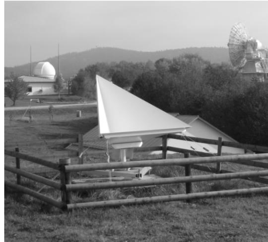
Abb. 1: Radarreflektor mit 1.5 m Kantenlänge am Geodätischen Observatorium Wetzell.
