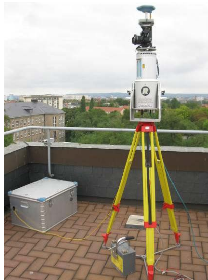
Abb. 1: Geodätische GNSS-Antenne auf einem Riegl LMS-Z420i Laserscanner
