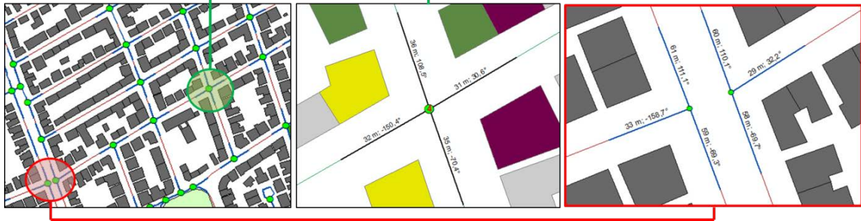
Abb. 9: Links: Ergebnisausschnitt für ein Wohngebiet der Stadt Braunschweig; Mitte: Beispiel einer korrekt analysierten Straßenkreuzung; Rechts: Beispiel eines zu hochaufgelösten Knotenpunktes
