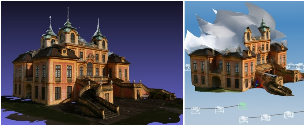
Abb. 6: 3D-Modell berechnet mit VisualSFM & CMPMVS (links) und 123D-Catch (rechts)
