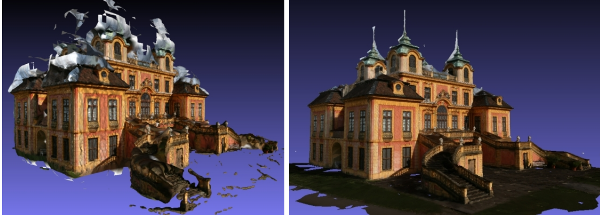
Abb. 2: 3D-Modell mit CMVS/PMVS2 (links) und CPMVS (rechts)
