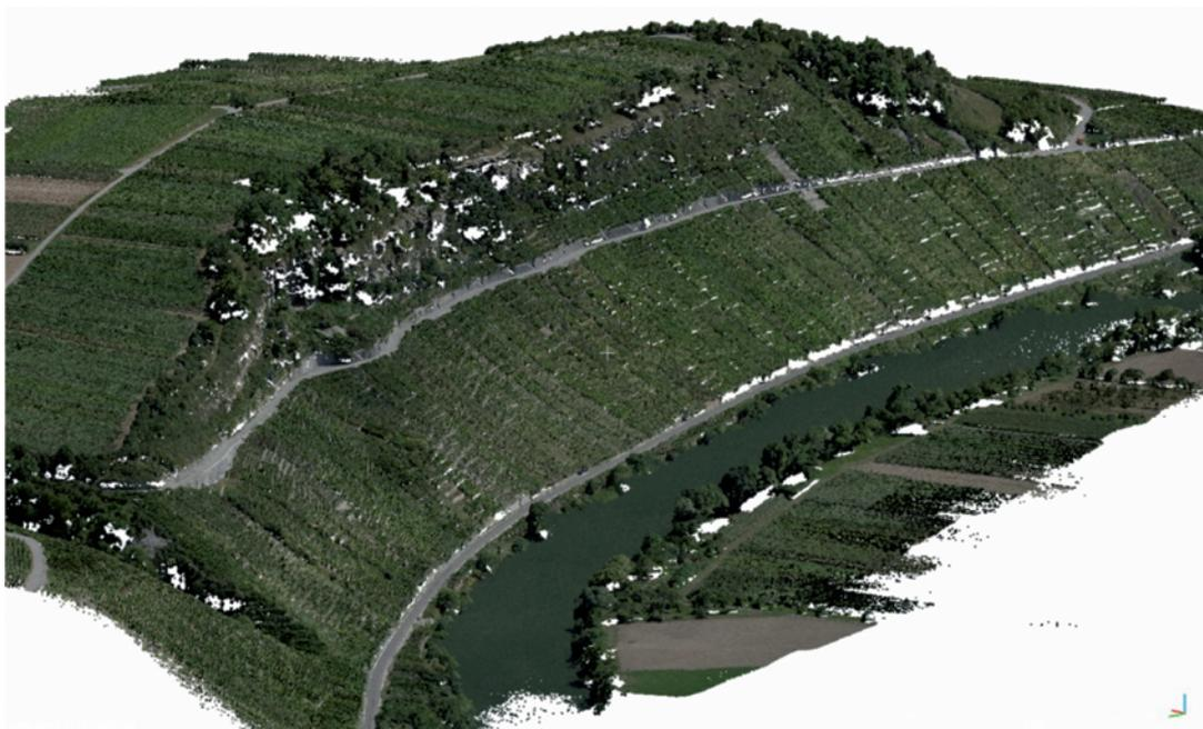
**Abb. 5:** Oberflächenmodell des Testgebiets aus Ricoh/Zeiss Befliegung.
