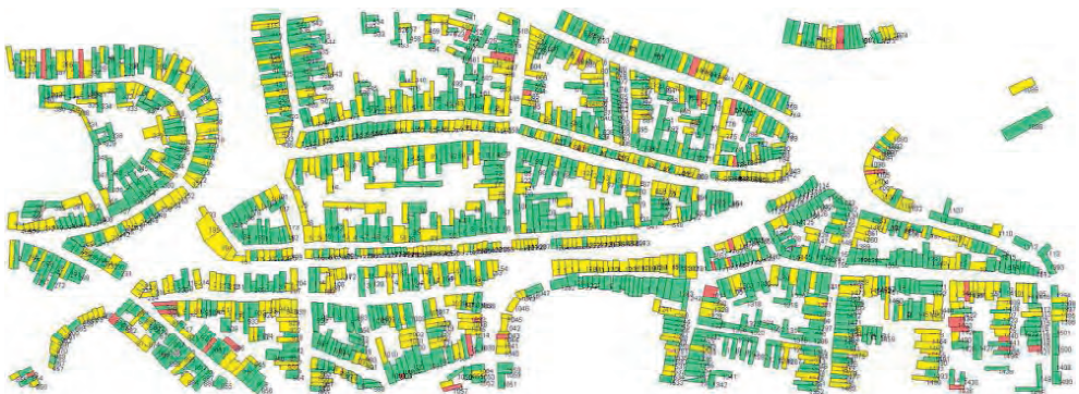
Abb. 5: Ergebnisse der Modellierungssoftware nach zwei Iterationen für Block 5 (Ostteil); Grün: NV < 3.3 , Gelb: NV > 3 ; 3, Rot: Dachneigung auf 0 gesetzt.
