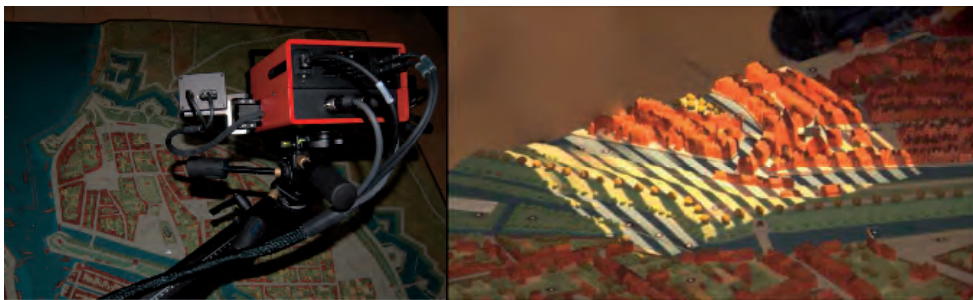
Abb. 2: Aufnahme des Holzmodells im Hamburgmuseum mit dem Streifenprojektionssystem ATOS I: Messsystem über dem Modell (links) und Aufnahme Fenster mit Streifenmuster im Messbereich (rechts).
