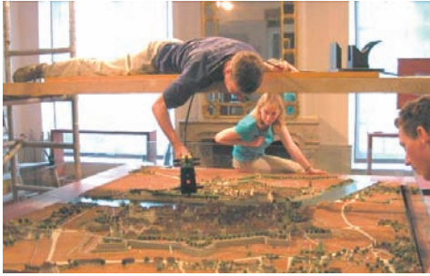
Abb. 4: Scannen des Stadtmodells mit T-SCAN.
