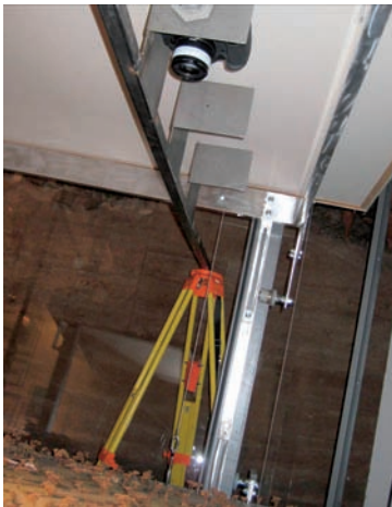
Abb. 4: Kameraaufhängung für die „Befliegung“ der Holzmodelle.
