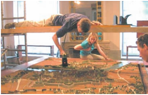
Abb. 4: Scannen des Stadtmodells mit T-SCAN.
