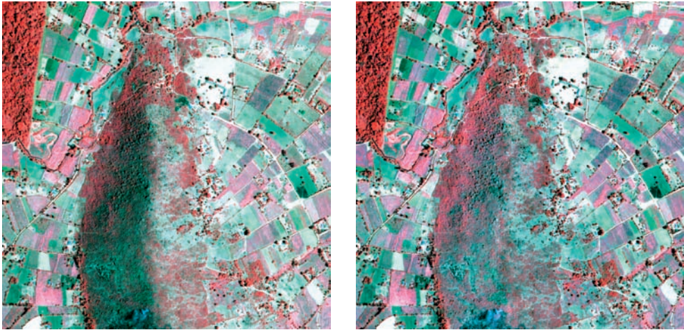
Abb. 6: Vor (links) und nach der ATCOR-Korrektur (rechts) von Einflüssen insbesondere hervorgerufen durch die Orographie (Ausschnitt: Kambiri Hill).
