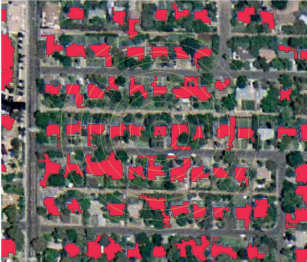
Abb. 4: Zentroid für ein Gebäude und Umkreise.
