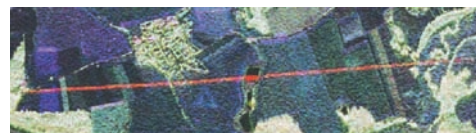
Abb. 5: Dipolstreuung an Hochspannungsleitung.
