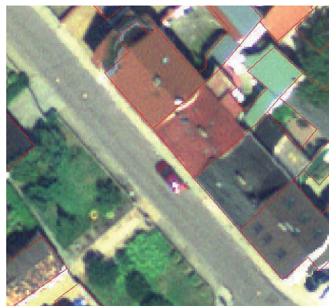
Abb. 1: Vergleich der Aufnahmegeometrien (mit überlagerten ALK-Daten, Ausschnitt ca. 40\text{ m} \times 40\text{ m} ): links (DMC): Zentralperspektive (starke radiale Verschiebungen), rechts (ADS 40): kombinierte Parallel- und Zentralperspektive des Linienscanners (leichte Verschiebungen quer zur Flugrichtung).
