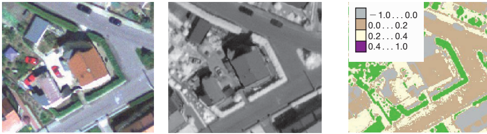
Abb. 3: links: ADS 40-Bilddaten (Ausschnitt ca. 50 m × 50 m), mitte: abgeleiteter NDVI, rechts: Grobklassifizierung basierend auf NDVI-Schwellwerten.
