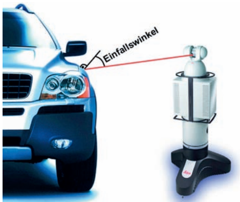
Abb. 2: Einfallswinkel ist der Winkel zwischen dem Laserstrahl und der Flächennormalen.
