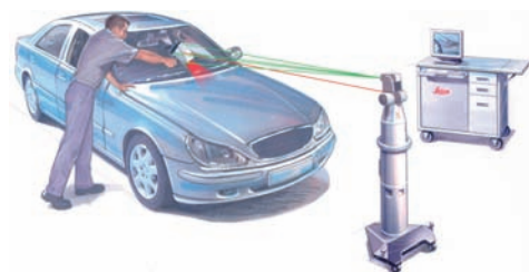
Abb. 11: T-Scan und Laser Tracker.
