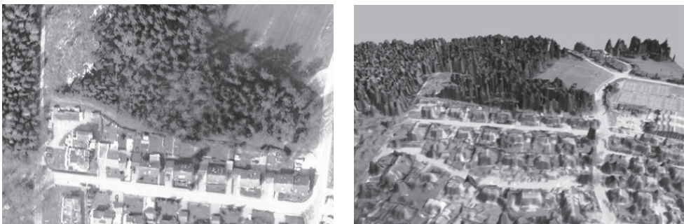
Abb. 1: Ausschnitt des multi-sensoralen Datensatzes: Multispektrale Bilddaten (links; Abdeckung ca. 400 m x 300 m) und Perspektivansicht nach Draping des Bildes auf das Digitale Oberflächen-Modell (rechts).
