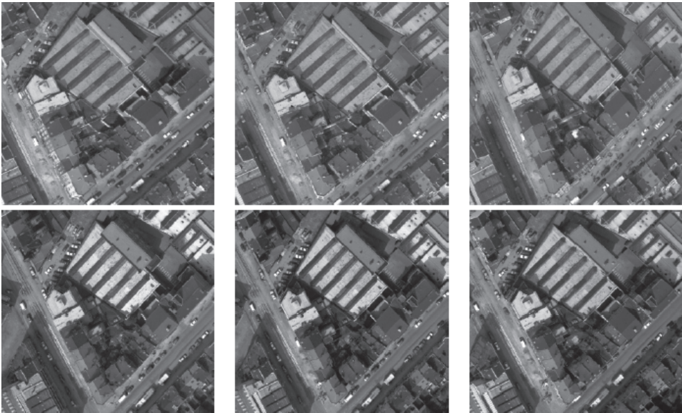
Abb. 9a: Ausgangsbilder für eine Gebäuderekonstruktion aus sechs sich überlappenden Bildern (aus BAILLARD et al. 1999).
