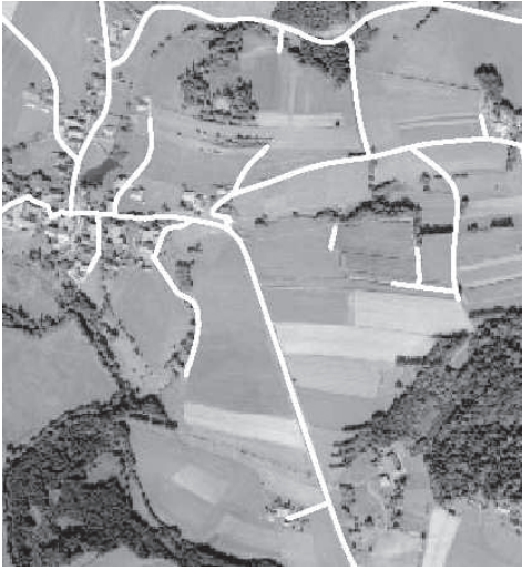
Abb. 8: Ergebnis einer automatischen Straßenextraktion im offenen Gelände (© Lehrstuhl für Photogrammetrie und Fernerkundung, Technische Universität München)
