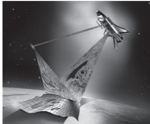
Abb. 4: SRTM, die Space Shuttle Topography Mission, eine interferometrische SAR Mission, die an Bord des Space Shuttle im Februar 2000 11 Tage die Erde umkreiste (© DLR, Oberpfaffenhofen).
