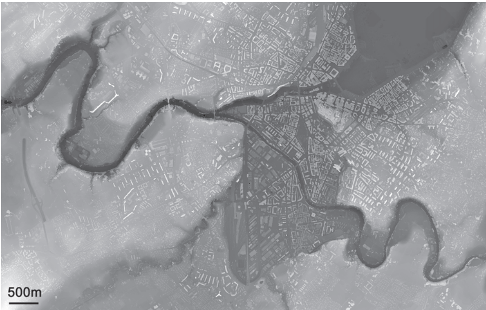
Abb. 4: Grauwert-kodiertes DOM, Genf, Schweiz (Ausschnitt), 1 m-Raster, 10 cm Höhengauflösung, HRSC-AX, Flughöhe 5000 m, April 2002 (prozessiert für SWISSPHOTO AG).
