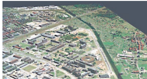
Abb. 7: Perspektivansicht eines DOM, mit RGB-Orthobild überlagert, Berlin, (Ausschnitt Adlershof), 1 m-Raster DOM, 10 cm Höhenauflösung, HRSC-AX, Flughöhe 5000 m, Mai 2001 (Perspektivansicht FPK GmbH, Berlin).
