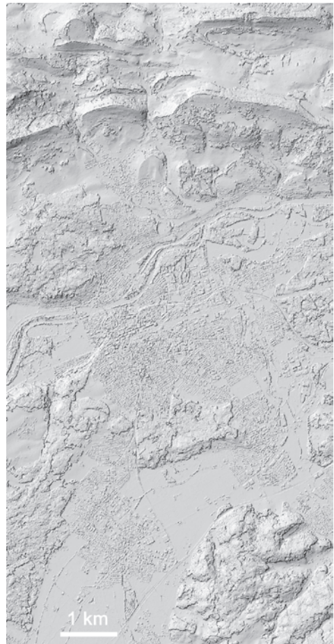
Abb. 8: Schattiertes DOM, Aarau, Schweiz (Ausschnitt), 1 m-Raster, 10 cm Höhenauflösung, HRSC-AX, Flughöhe 5000 m, Februar 2002 (prozessiert für SWISSPHOTO AG).
