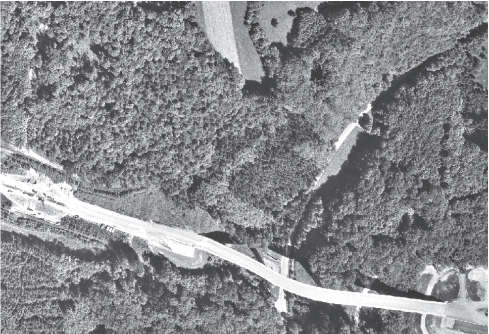
Abb. 3: Auf DGM basierendes Orthobild mit „fehlplatziertes“ Brücke und korrekt verlaufendem Schatten.
