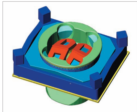
Abb. 3: Panchromatische Kanäle in der kreiselstabilisierten Aufhängung.
