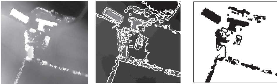
Abb. 8: Laserscanning-DOM (links, Ausschnitt ca. 250 m × 240 m, © TopoSys) sowie Ergebnisse der Segmentierung (Mitte) und Klassifizierung (rechts, Reduktionsflächen in schwarz).
