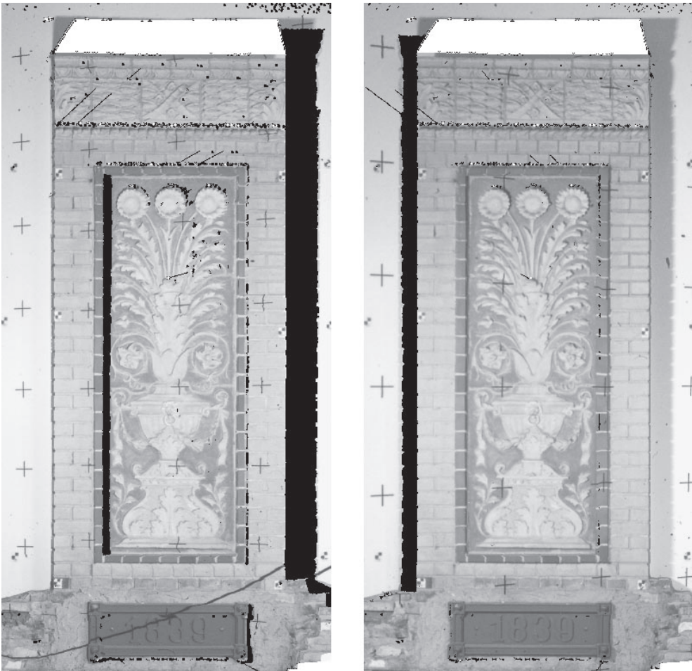
Abb. 8: Zwei Orthophotos, berechnet aus unterschiedlichen, von verschiedenen Standpunkten aus aufgenommenen Originalbildern. Weiße Bereiche repräsentieren Gebiete ohne Laserscanner-Daten, schwarze Bereiche sind sichttote Räume in den Bildern. Im linken Bild ist unten ein Kabel zu sehen.
