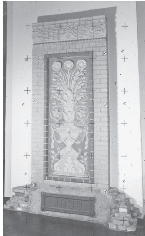
Abb. 4: Fotografie des Objektes „Reliefe“, aufgenommen mit einer Rolleiflex 6006 metric mit einem 50-mm Objektiv.
